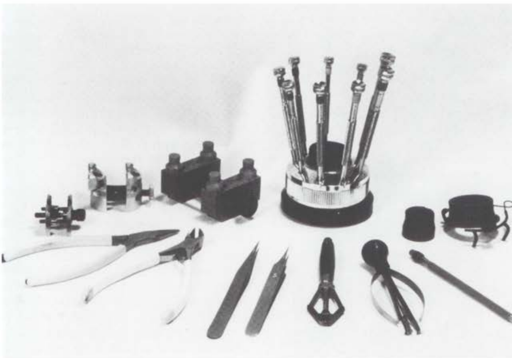
2 Die wesentlichsten Handwerk- zeuge für die Taschenuhrreparatur: von links nach rechts: Hintere Reihe – drei Uhrwerkhalter, Schraubenzieher, Uhrmacherlupe mit Zusatzlinse. Vordere Reihe – Kombizange, Seitenschneider, Pinzetten, Zeiger- abheber (zwei Typen), feiner Stif- tenkloben
