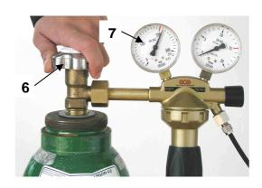
Absperrventil (4) öffnen und am PUK Schweißgerät den Leistungsregler gedrückt halten um das Gasventil im Schweißgerät zu öffnen.
