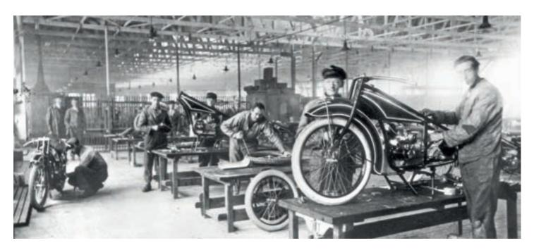
> Die Produktion der R 32 in den frühen 1920er Jahren glich noch einer mittelalterlichen Manufaktur. 1924 wurden täglich etwa fünf Motorräder fertiggestellt.
