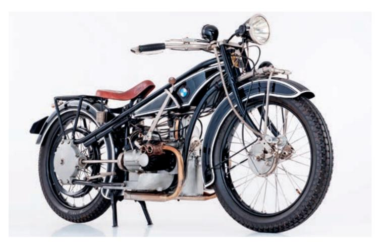
> Eine R 32 der Baujahre 1925/26, die Lampe ist immer noch Option, die jetzt auf das Vorderrad wirkende Handbremse wird aber serienmäßig eingebaut.
