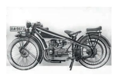
> Noch eine R 32 von 1924, jetzt mit Vollausstattung: Ballhupe, Boschhorn, Lichtanlage (Schaltkasten im Rahmenheck) und Soziussitz mit eingeklappten Fußrasten aus einfachem Blechprofil. Das Kennzeichen weist den Stadtbezirk München aus.
