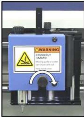
5. Stellen Sie die Höhe des L- Werkzeuges so ein, um eine richtige Höhe für die Gravur zu erhalten. Sie können das L- Werkzeug einmal auf einen Ring fixieren und einmal auf Armreifen. Stellen Sie die Festspannschraube wieder fest.
