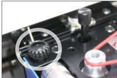
1. Ersetzen Sie das Werkzeug durch den V- Cutter und führen Sie wie beim Werkzeugwechsel beschrieben, die automatische Messung der Werkzeuglänge durch .
