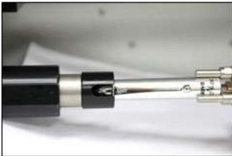
Spannhalter für Füllergravur einsetzen
