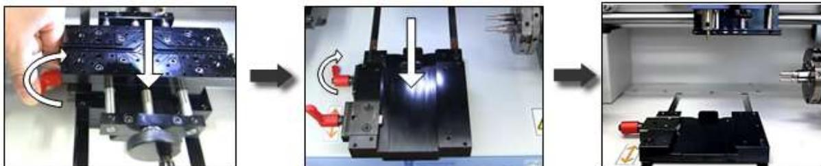
2. Spannen Sie einen Ring in die Ringhalterung ( maximaler Außendurchmesser 18 mm)
