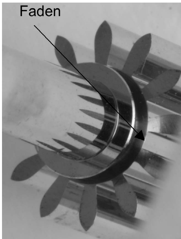
Abb. 6.6.1.3 „Klassisch“ eingedrehtes Trieb für eine feine Uhr: Der „Faden“ ist ganz zart am Beginn der Triebzähne sichtbar und gilt als Qualitätsmerkmal für den Rundlauf des Triebes.
