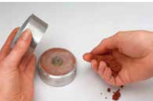
**1** Den Sand zerkleinern, Klumpen zerbröseln und in die Ringhälfte mit dem Randabschluss füllen und mit einem Hammer verdichten. Weiteren Sand zugeben und mit dem Lineal glätten. Das Objekt in den Sand drücken und die ganze Oberfläche mit Talkum bestäuben.
