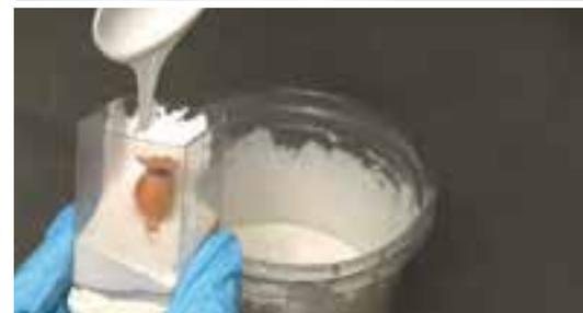
**4** Den Silikonblock aus dem Behälter lösen, den Gusskanal entfernen. Die Form mit dem Skalpell einschneiden, die Kapsel entnehmen. Fest mit Kreppband umwickeln, lassen sich mit der Form Kapseln aus Wachs, Gips oder Gießharz anfertigen.
