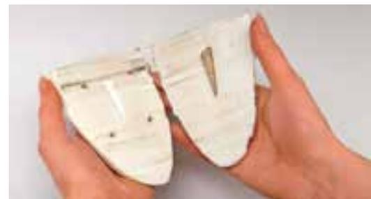
**2** Die Sepiahälften zusammendrücken, bis sie fest schließen. Wieder lösen und das Urmodell entfernen. Mit dem Messer einen Eingusskanal schnitzen und mit der Reißnadel von der Gussmulde aus Entlüftungskanäle zu einer Seite ritzen.
