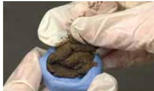
**4** Den Gießling aus der Form lösen und in einem gut belüfteten Raum abbürsten.
