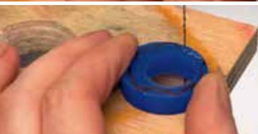
**2** Mit dem Spiralsägeblatt größere Partien Wachs abtragen. Wenn Sie nach Schablone arbeiten, lassen Sie etwas Überstand, den Sie später wegfeilen können.
