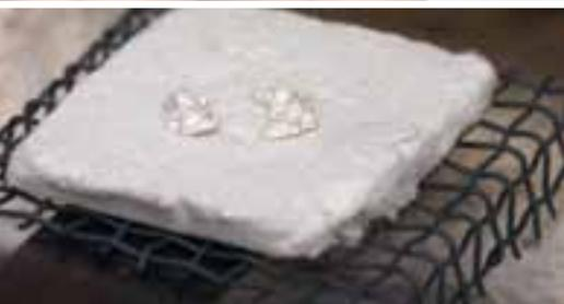
**3** Die Masse im Brennofen nach Herstelleranweisungen brennen und abschrecken oder an der Luft abkühlen lassen.
