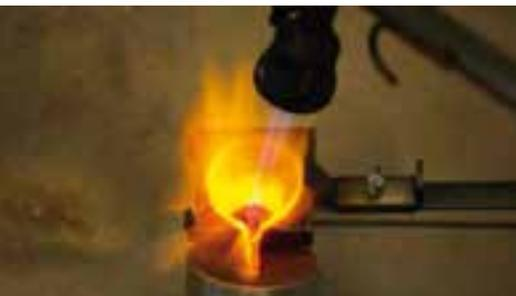
**3** Sicherstellen, dass kein loser Sand in der Mulde liegt, da er ins Metall eingebettet würde. Das Metall unter Zugabe einer Prise Borax im Tiegel schmelzen. Beim Gießen die Brennerflamme auf das flüssige Metall richten.
