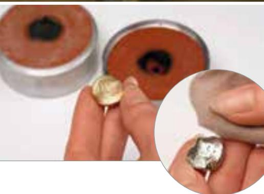
**4** Die Ringe in kaltem Wasser abschrecken und öffnen. Den Gießling entnehmen, Oxidreste abbeizen, überschüssiges Metall absägen und das Stück säubern.
