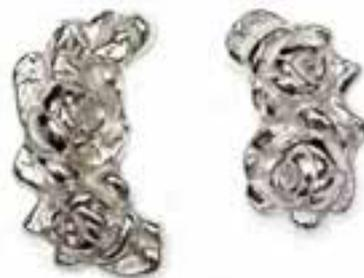
**4** Nun kann das Stück gefeilt, gebohrt und gelötet werden. Feinheiten arbeitet man vor dem Polieren in der Trommel aus, das zum Kalthärten dient und das Finish haltbarer macht.
