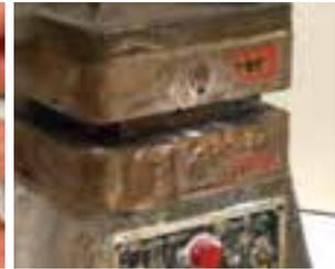
**4** Beiderseits des Rahmens Stahlplatten anlegen, damit das Gummi nicht an den Heizplatten festbackt. Den Rahmen in die vorgeheizte Vulkanisierpresse legen und fest einspannen. Die Aushärtzeit hängt von der Zahl der Gummischichten ab (meist zwischen 30 und 50 Minuten). Nach zehn Minuten nachspannen.
