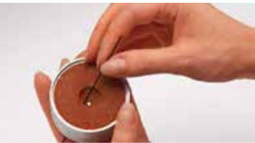
**2** Die obere Hälfte des Rings auf die untere setzen. Sand einfüllen und verdichten. Beide Teile trennen und das abgeformte Objekt herauslösen. Einen Eingusskanal schneiden und mit einem Stäbchen Entlüftungsöffnungen bohren (sie dürfen den Eingusskanal nicht kreuzen).
