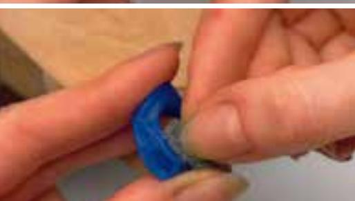
**5** Mit feiner Stahlwolle die Oberfläche polieren und Kratzer entfernen, dabei keine Details beschädigen. Der Wachsring kann nun für das Ausschmelzverfahren mit einem Eingusskanal versehen werden.
