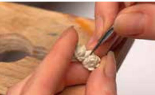
**2** Nach dem Austrocknen wird das Stück aus der Form genommen und mit Feilen und Schleifpapier gesäubert (das geht jetzt schneller als nach dem Brennen). Mit Schnitzwerkzeugen Feinheiten herausarbeiten.
