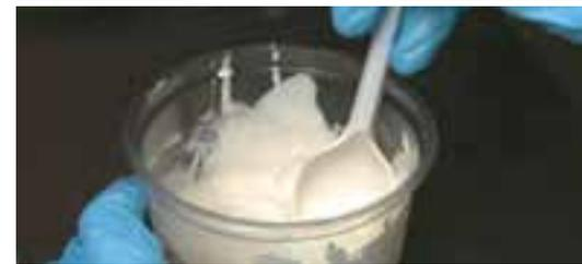
**3** Mit einem Plastiklöffel das Silikon seitlich in die Gussform laufen und um den Gegenstand herum ansteigen lassen, damit möglichst keine Luft eingeschlossen wird. Den Behälter füllen, bis das Objekt gut bedeckt ist. 24 Stunden aushärten lassen.
