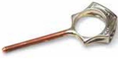
**1** Das gegossene Urmodell wird gesäubert und poliert und benötigt dann einen angesetzten Gusskanal, durch den das Wachs später in die Form gespritzt wird. Für die Positivform lötet man meist ein Stück 3 mm starken Draht aus unedlem Metall mit Weichlot an das Objekt.
