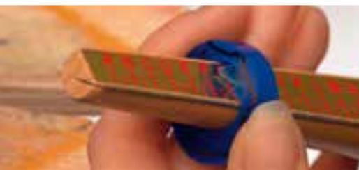
**1** Durch behutsames Drehen auf dem Wachsriegel (mit Messer) die Innenweite des Rings auf die richtige Größe erweitern. Den Ring dabei wenden, da der Riegel konisch ist.
