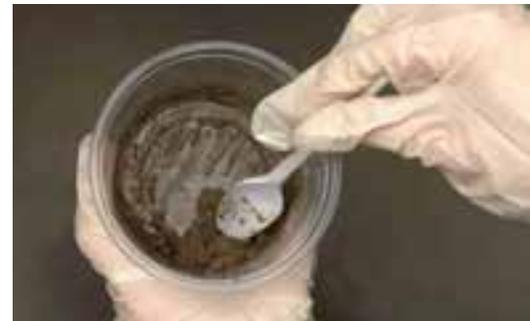
**3** Die Masse in die vorbereitete Form drücken (hier ein Abdruck aus Silikon-Abformmaterial). Die Form in ein feuchtes Tuch wickeln und über Nacht abbinden lassen.
