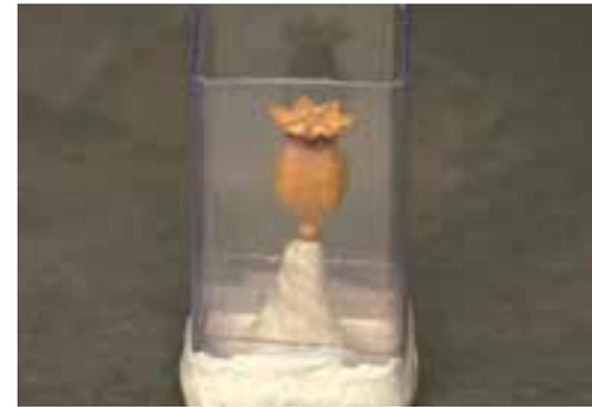
**2** Einen Plastikbehälter auf die Waage stellen und Silikon für den Gussbehälter einfüllen. Anhand des Gewichts die Katalysatormenge berechnen, Aktivator zugeben und vermischen. Mit einer Vakuumpumpe Luftblasen absaugen.
