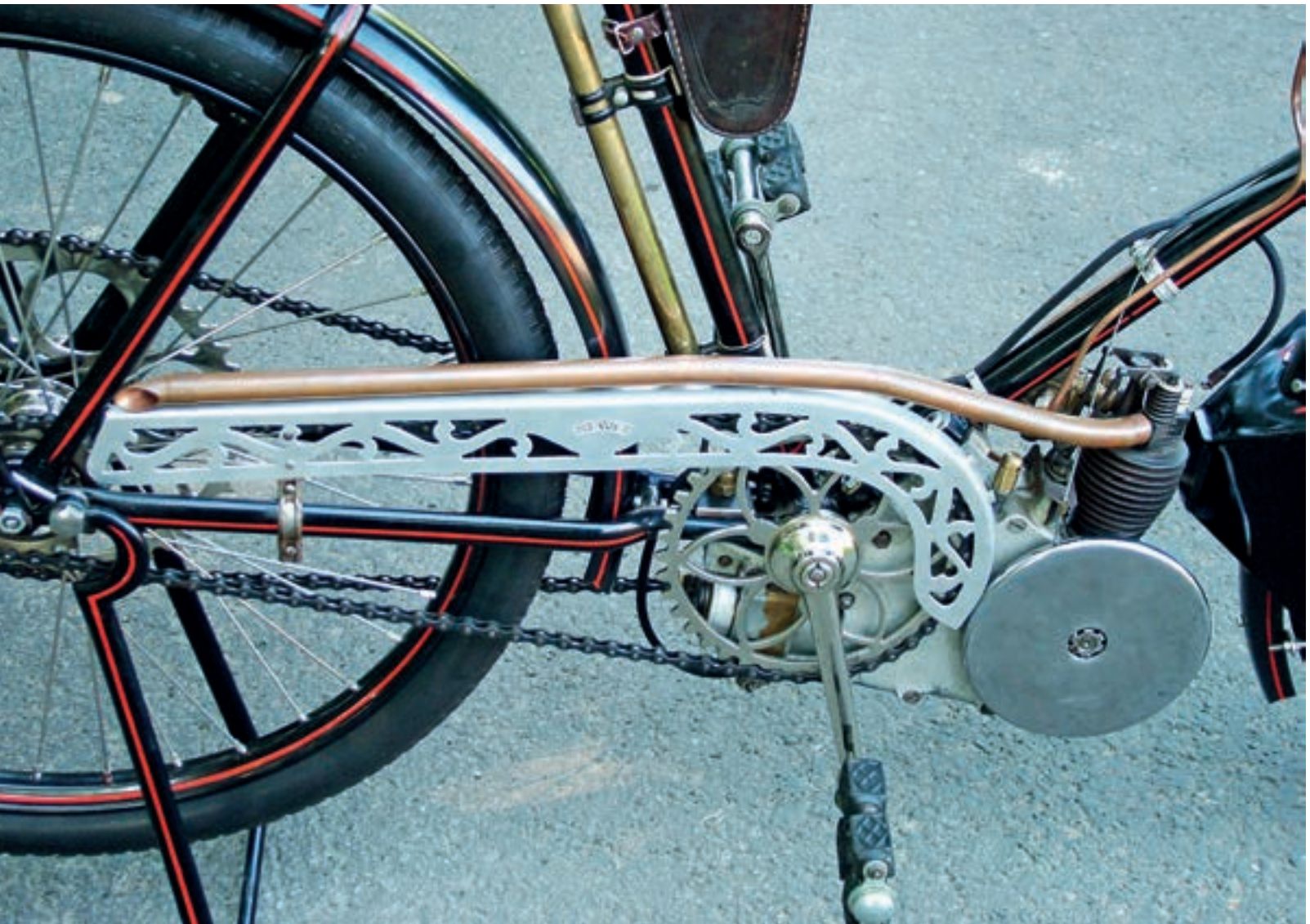
Auf der rechten Seite ist die außen liegende Schwungscheibe des kopfgesteuerten, getriebelosen Motors angebracht.
