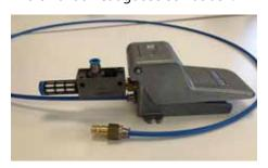
**7.** Schlauch (Ref. 4360039) in die Schlauchschnellkupplung (blau) des Einschraubanschluß (mit Schlauchkupplung) Ref. 233489 stecken und mit Fußventil verbinden (Einschraubanschluß Ref. 233489 am Fußventil)
