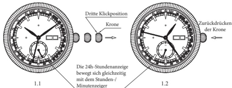
**BITTE BEACHTEN SIE:** Die Uhrzeit darf nicht während der Zeit zwischen 21 Uhr und 3 Uhr eingestellt werden, da dies das Uhrwerk nachhaltig beschädigen kann.
